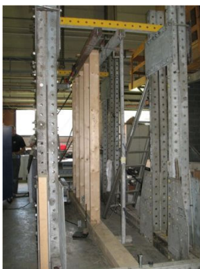
Bepaling van de schrankweerstand Proefopstelling bij het WTCB te Limelette
